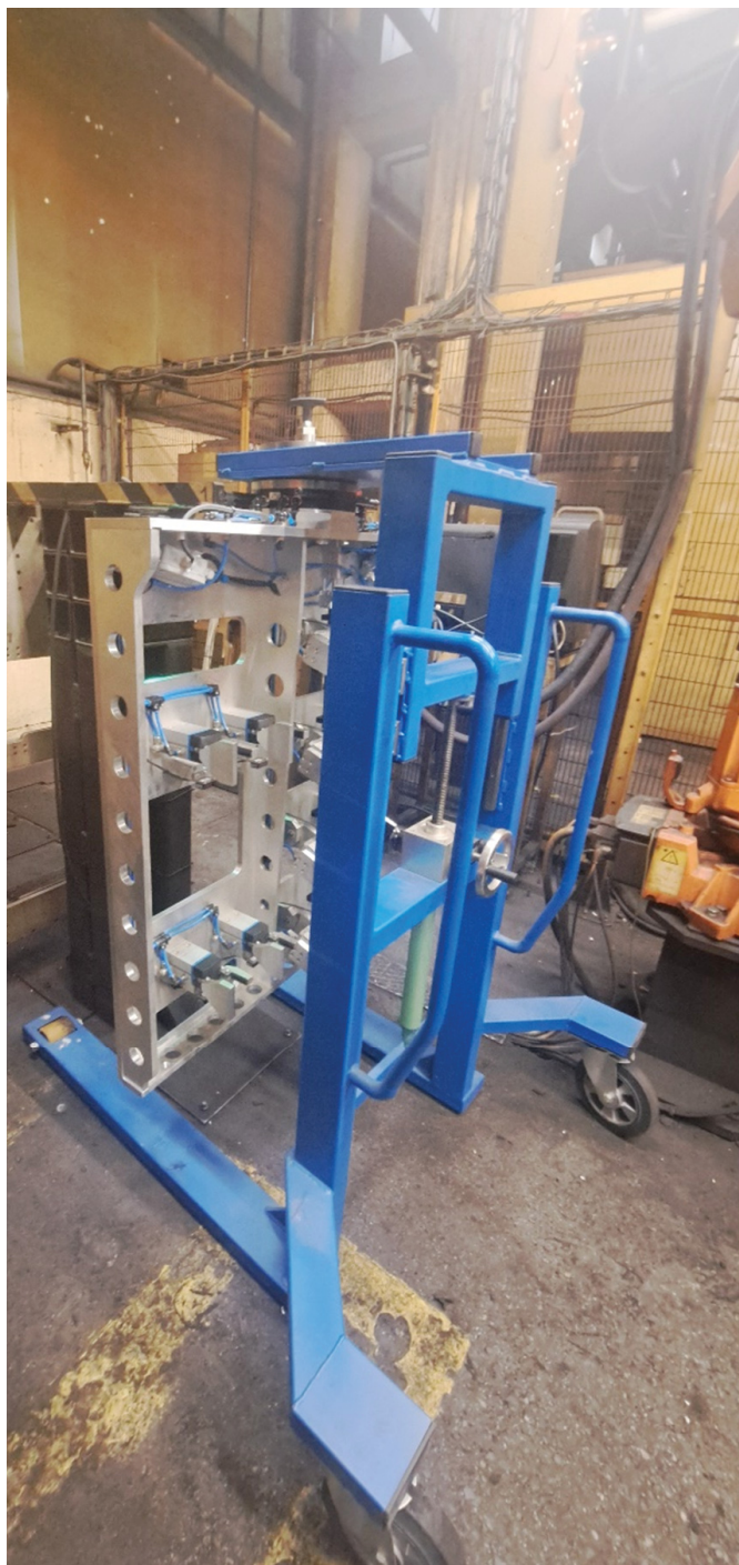
Obr. 4 Manipulačný vozík s upnutým odoberacím prípravkom pred stojanom
